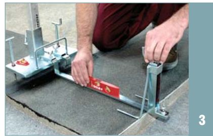
kontrola vodorovné polohy vodicích lišt
